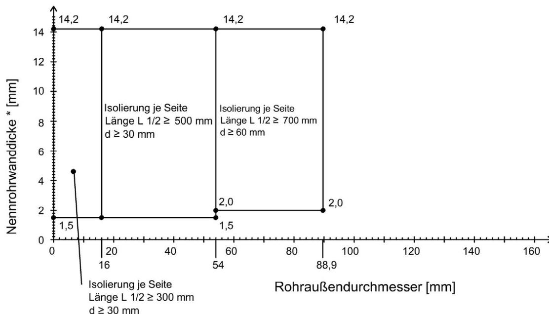
Für die Rohr- oder Streckenisolierungen sind Mineralwolle-Matten oder Mineralwoll-Schalen gemäß Abschnitt 2.1.7 zu verwenden (s. Anlage 14)
