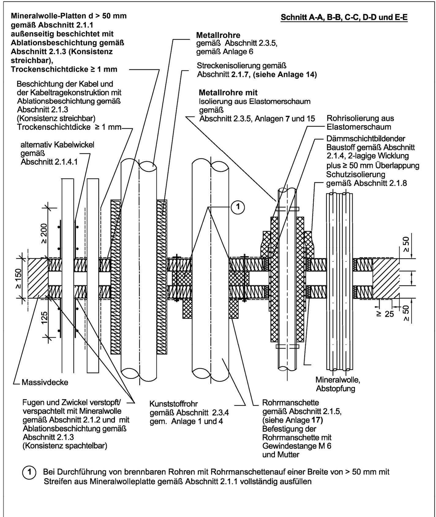
Feuerwiderstandsfähige Abschottung für elektrische Leitungen und/oder Rohrleitungen aus Kunststoff oder Metall "Flammotect COMBI 90"
