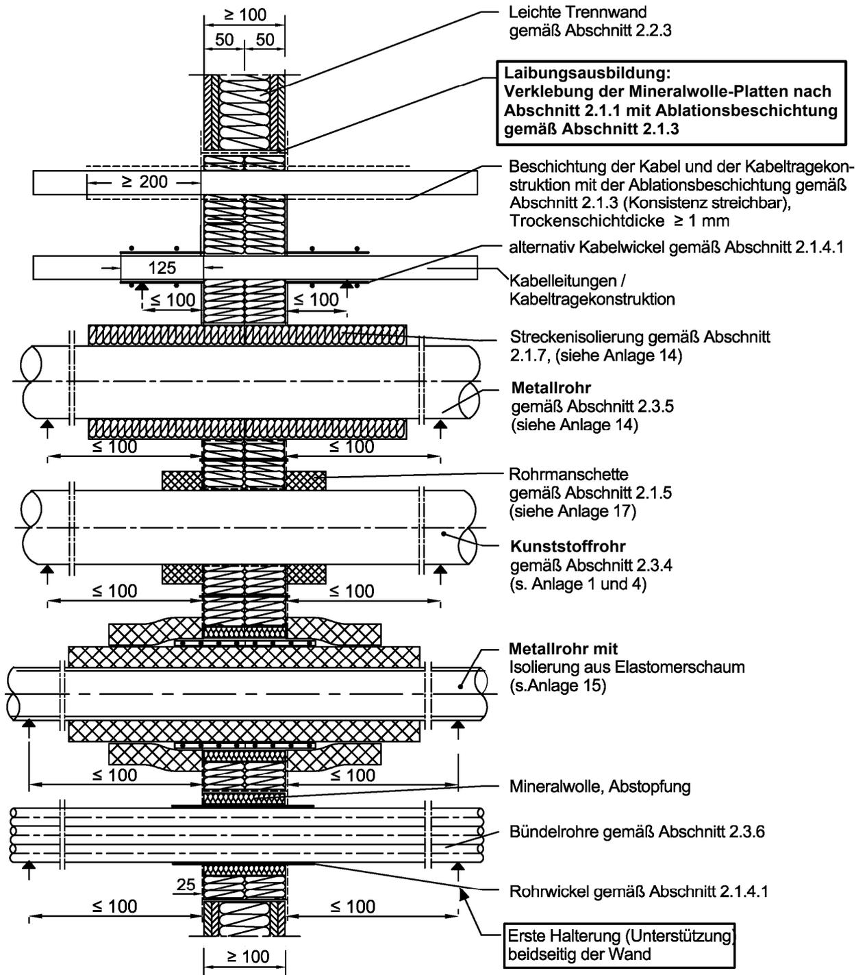
Feuerwiderstandsfähige Abschottung für elektrische Leitungen und/oder Rohrleitungen aus Kunststoff oder Metall "Flammotect COMBI 90"
