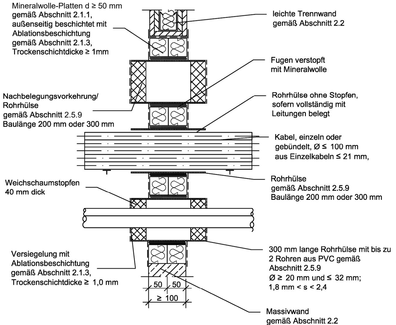
Feuerwiderstandsfähige Abschottung für elektrische Leitungen und/oder Rohrleitungen
